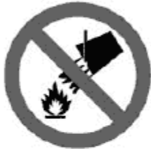
НЕ ГАСИ ВОДОМ
